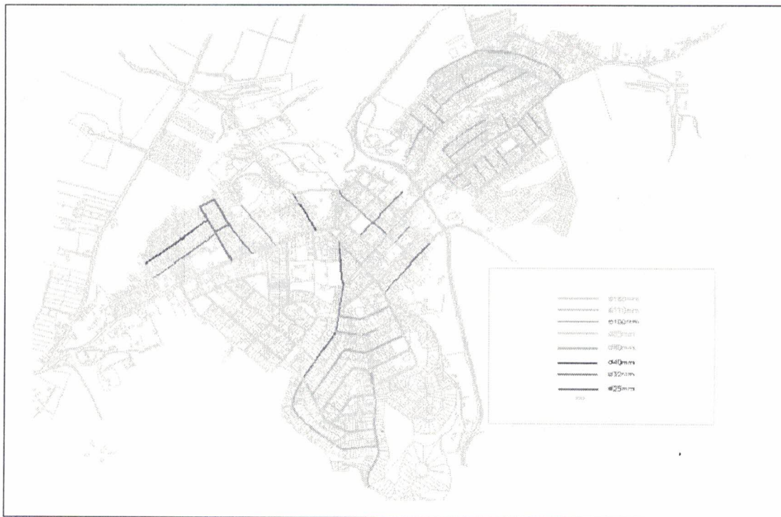
Figura 12 – Cadastro da rede de distribuição de água
